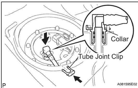
12. **CONNECT FUEL PUMP TUBE SUB-ASSEMBLY**
