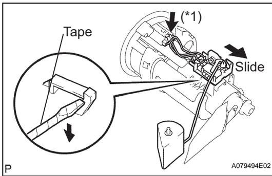
**11. REMOVE FUEL SENDER GAUGE ASSEMBLY**
