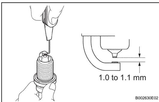
(d) Check the spark plug electrode gap.
